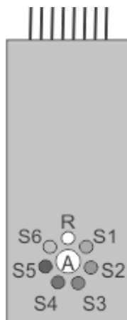
Fig. 1. Configuración de la red de sensores: electrodo de referencias (R), electrodo auxiliar (A), sensor 1 (PPy/DBS); sensor 2 (PPy/AQDS); sensor 3 (PPy/PC); sensor 4 (PPy(pTS); sensor 5 (PPy/SF); sensor 6 (PPy/FCN).
