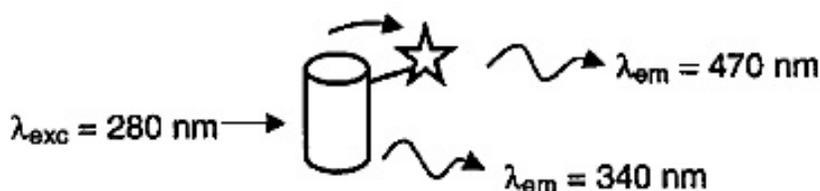
Esquema 3. Mecanismo de transferencia de energía entre fluorocromos. El cilindro representa la molécula de albúmina y la estrella representa el dansilo unido a ella. Adaptado de Levi y González-Flecha (2003).
