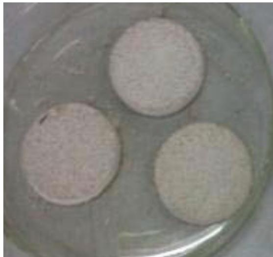
Fig. 3. Membranas de zeolita natural para la purificación del biogás.
